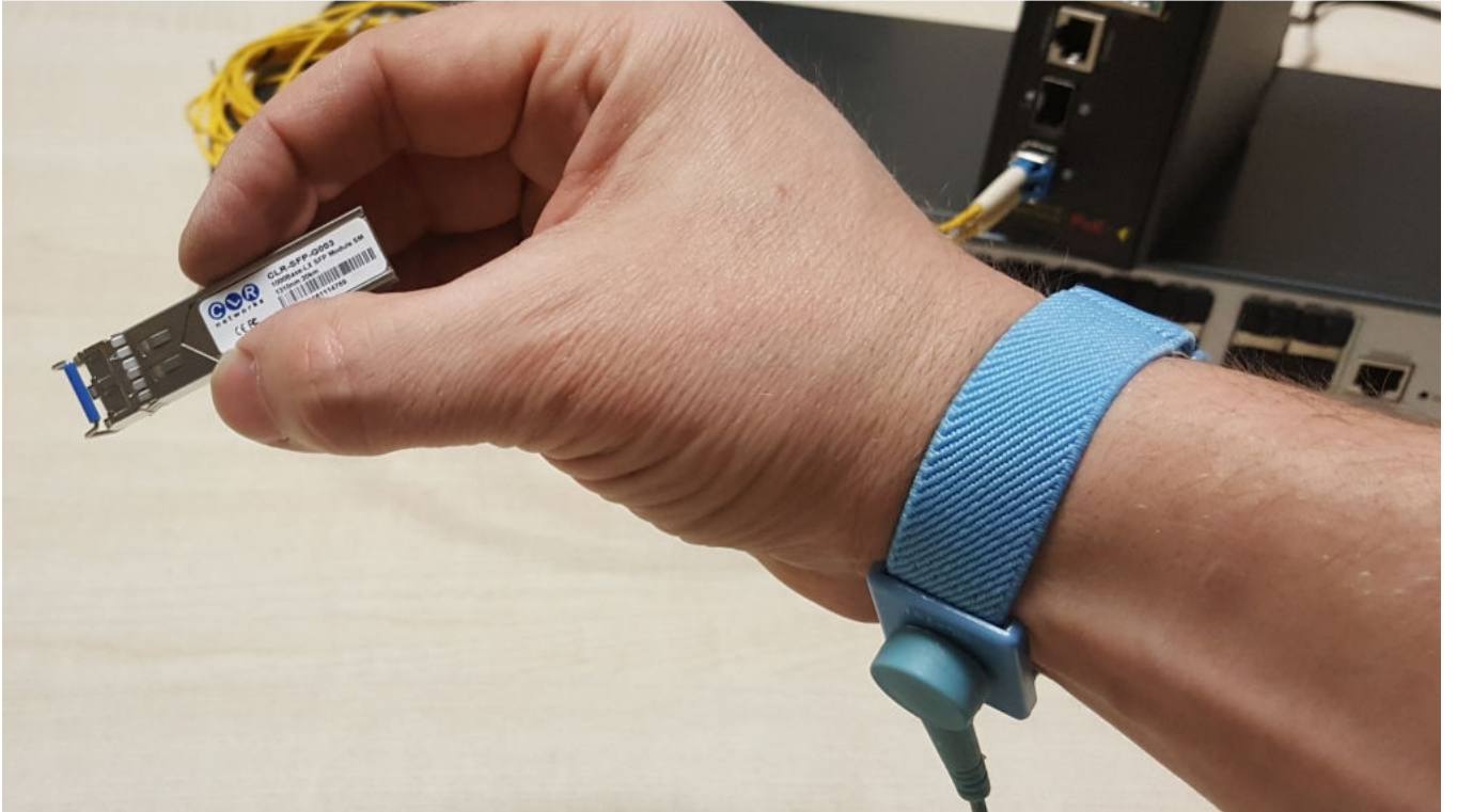
Resim 2. Anti-statik bilekliğ in takılış ı
