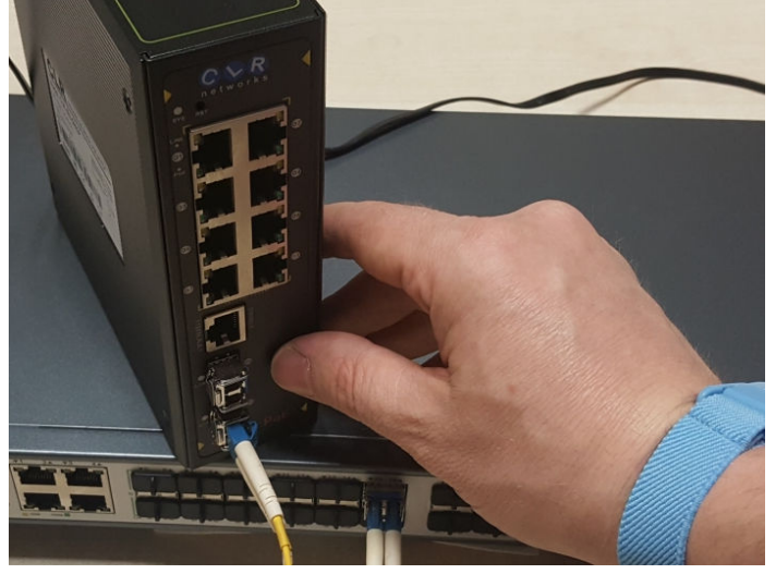
Resim 7. SFP modülün mandalının kapatılması
